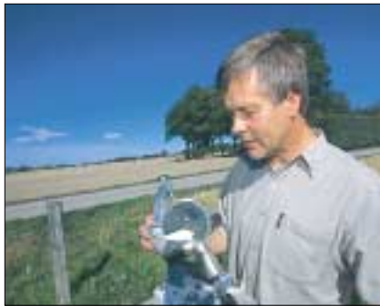
Med hjälp av ett klotformat brännglas anger heliografen antalet soltimmar på en pappersremsa. Distriktsförsöksledare Johan Roland läser av den soliga dagens avtryck i papperet.
